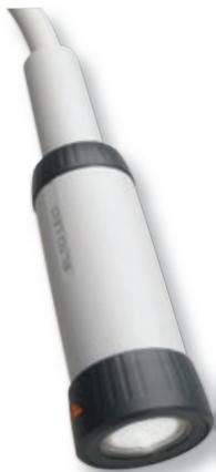
Светодиодный осветитель EL 10 LED отличается абсолютно однородным полем освещения. Интенсивность света можно регулировать в диапазоне от 6500 до 45 000 люксов. Размер диаметра пятна регулируется от 8,5 до 14 см. Рабочее расстояние для обоих параметров — 30 см.
