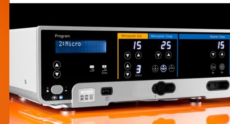
В программе Micro для использования микроэлектродов-игл применяются точно регулируемые токи.
